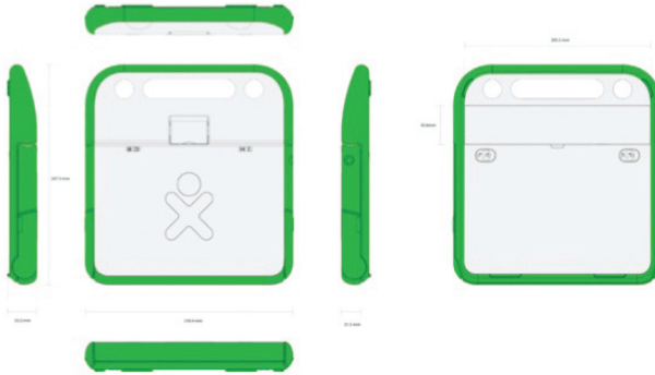
รูปที่ 3.5 แสดงชิ้นส่วนหลักของเปลือก XO-1 ซึ่งประกอบไปด้วยยางและพลาสติกที่มีความทนทานสูง
