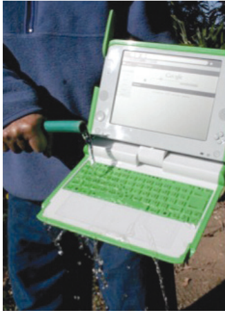
รูปที่ 3.6 แป้นพิมพ์ยางกันน้ำกันฝุ่น (ซ้าย) และการทดสอบเครื่องที่อุณหภูมิและความชื้นสูง (ขวา)
