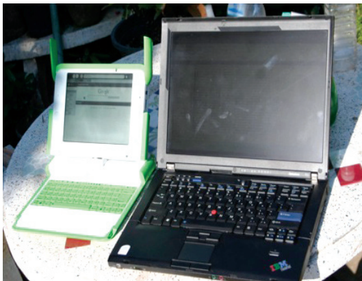
รูปที่ 3.8 เปรียบเทียบจอภาพของเครื่อง XO-1 กับจอภาพของคอมพิวเตอร์พกพาทั่วไปเมื่อใช้งานกลางแจ้งแดด
